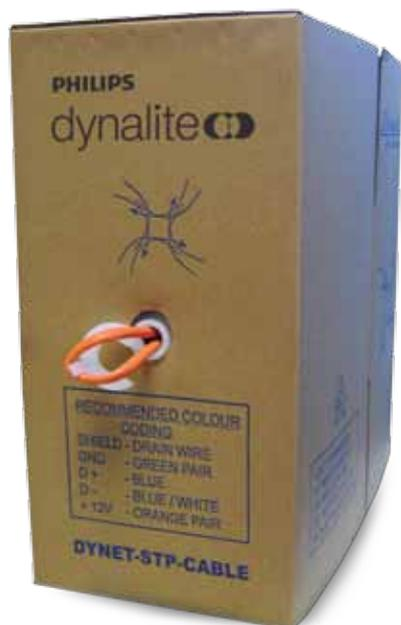
El cable de datos DyNet está expresamente diseñado para el cableado de red RS485 con una alta fiabilidad. Además de un par trenzado para los datos RS485, se facilitan conductores para suministrar c.c. a los periféricos alimentados de la propia red. Los conductores están apantallados para procurar la máxima integridad de los datos. El cable de datos es flexible porque todos los
