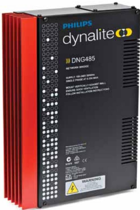
El modelo DNG485 de Philips Dynalite es un flexible puente de comunicaciones diseñado para redes RS485. Los dos puertos RS485 optoaislados permiten al DNG485 implementar una topología 'backbone' para grandes proyectos, proviendo de alta velocidad al bus principal para repartir a los distintos sub-buses.
