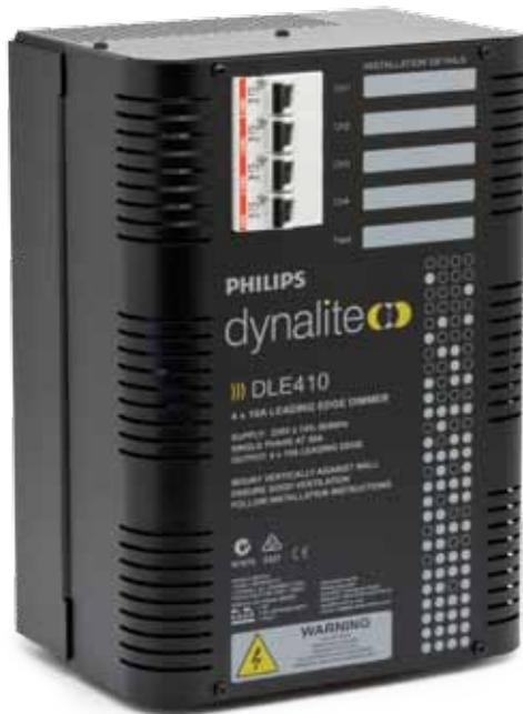
El DLE410 es un controlador de gestión de energía de cuatro canales con una carga máxima por canal de 10 A. Es apropiado para el uso con lámparas incandescentes, baja tensión, neón y determinadas fuentes de luz fluorescentes.
