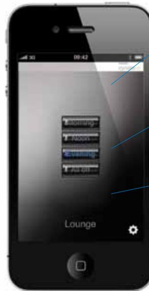
Los niveles de iluminación individuales pueden regularse fácilmente y después memorizarse en un botón para recuperarlos más adelante. Estos ajustes posteriormente se guardan en una botonera de control local de la sala para posibilitar la edición de los niveles de iluminación del sistema.
