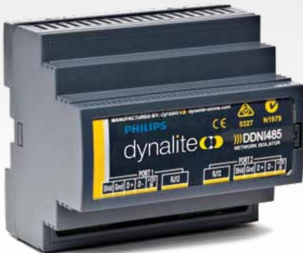
El modelo DDNI485 de Philips Dynalite está diseñado para el optoaislamiento rentable de las redes DyNet RS485. Los dos puertos RS485 optoaislados permiten a la pasarela DDNI485 implementar una topología en 'backbone', con cada ramal aislado eléctricamente de los otros para limitar el fallo a una sección de la red. Se trata de un dispositivo "pasivo" que no requiere programación.
